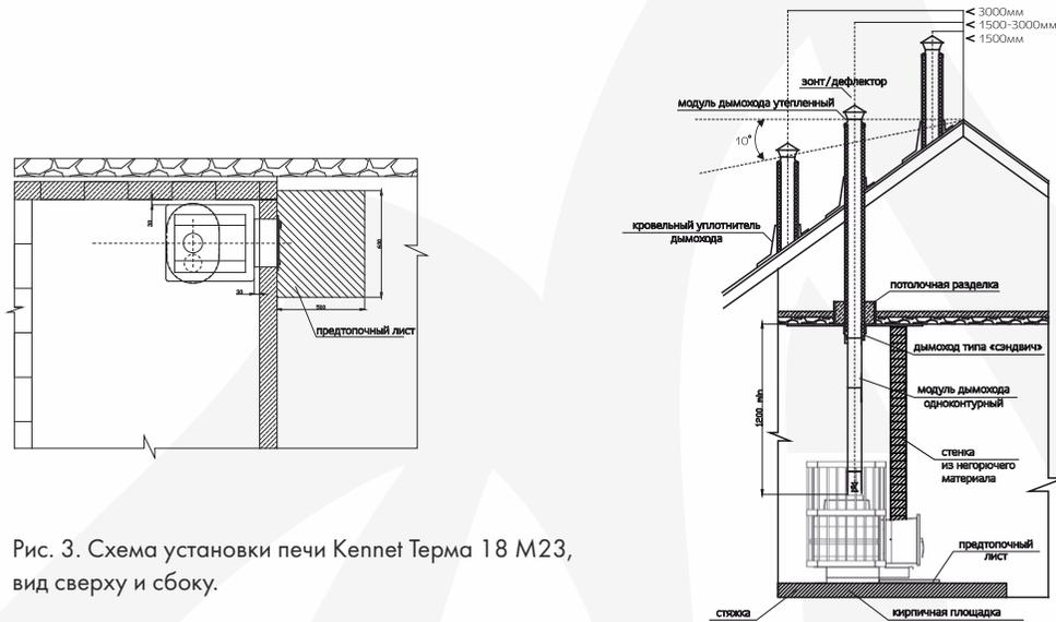
Рис. 3. Схема установки печи Kenet Терма 18 M23, вид сверху и сбоку.
